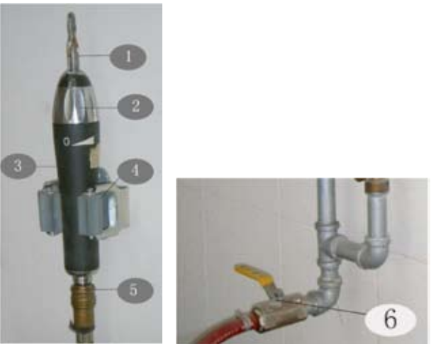
图 3-1-120 气动钻凿结构
