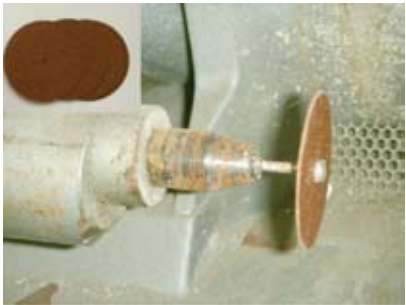
图 3-1-231 切割砂片 用于切割铸件
