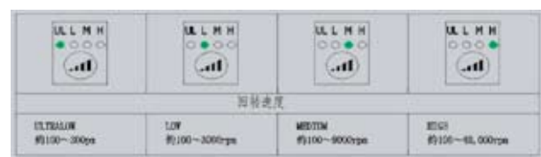
图 3-1-17 手机操作盘转速选择按钮
