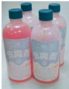
图 3-1-207 分离剂 制作义齿时，涂布分离剂分离石膏和蜡型或塑料
