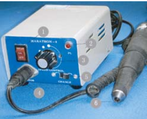
图 3-1-90 台式打磨机结构
