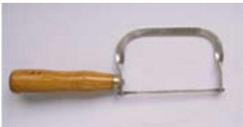
图 3-1-225 间齿锯 用于固定义齿制作时，切割石膏模型
