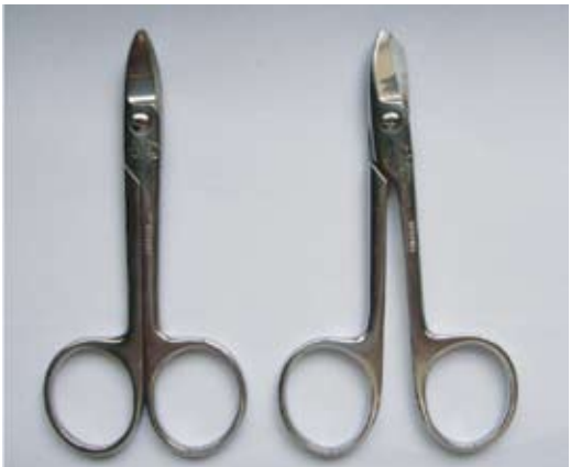
图 3-1-254 图左为弯剪刀,用于修剪;图右为直剪刀,用于剪石膏
