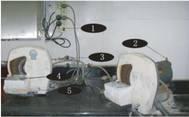
图 3-1-98 湿性修整机结构
