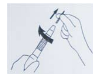
图 3-1-48 拆直型机头的切削工具
