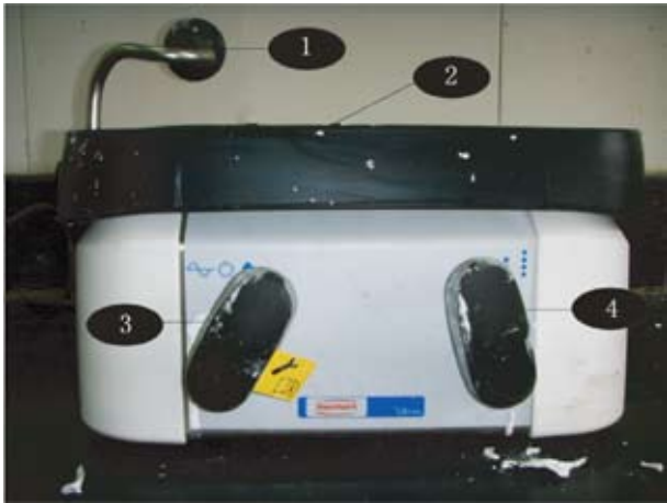
图 3-1-102 技工振荡器结构
